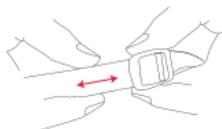
**Die Reißleine muss vollständig gespannt sein, wenn Sie auf den Steigbügeln stehen.** Die Länge der Reißleine lässt sich mit der Schnalle verstellen. Sie können die Länge der Reißleine auch ausgehend von der Widerristhöhe des Pferdes mit Hilfe der untenstehenden Tabelle bestimmen. Die Länge der Reißleine wird zwischen der Kugel und der Verbindungsstelle der beiden an den Sturzfedern eingehängten Riemen gemessen.
