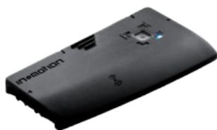
La In&box se mettra en veille automatiquement si elle reste immobile pendant 5 minutes. La batterie de la In&box a une durée approximative de 20 heures de roulage continu.
